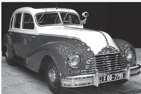
*EMW 340-2 aus dem Jahre 1952, 6 Zylinder 54 PS Reihenmotor mit 1971 ccm.
